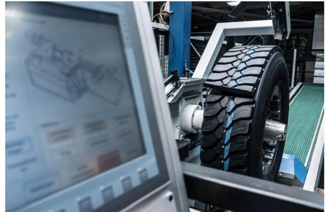
Bildunterschrift: Vulkanisierter Profilstreifen wird auf die Karkasse aufgebracht.
