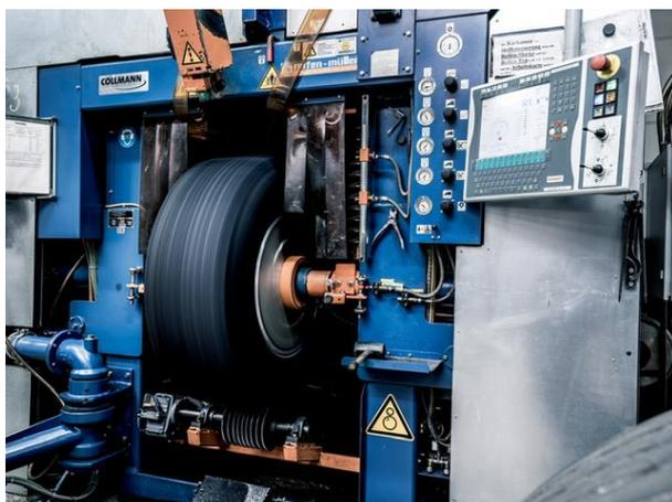
Bildunterschrift: Beim Abrauen werden Altgummireste vollständig von der Karkasse entfernt und eine der Karkassenbauart angepasste Oberfläche erzeugt.
