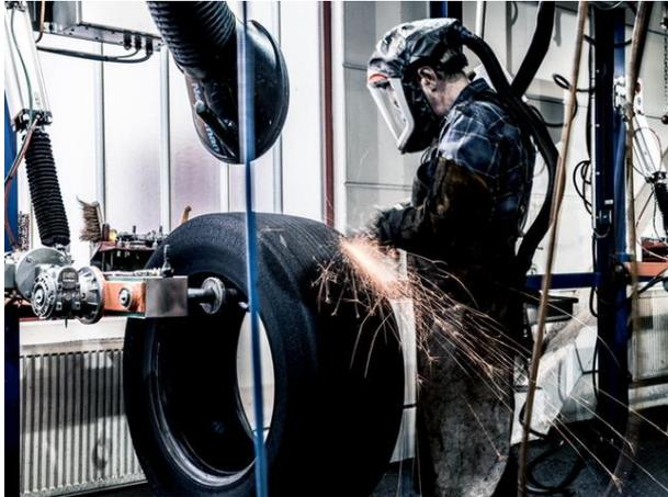
Bildunterschrift: Die erzeugte Oberfläche wird auf etwaige Beschädigungen überprüft, Abweichungen werden durch Fachkräfte behoben.
